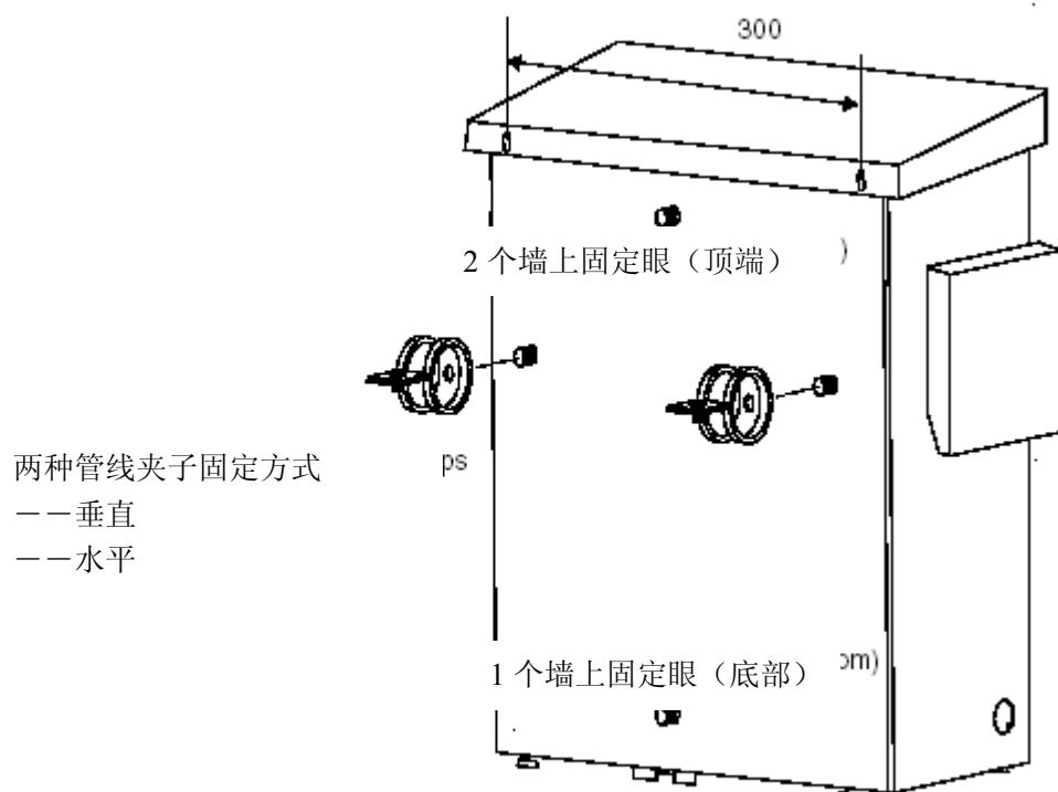
图 3 管线和墙壁固定图示
