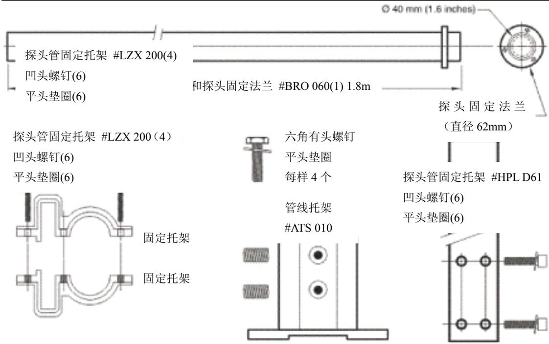
图 5 固定点安装工具包
