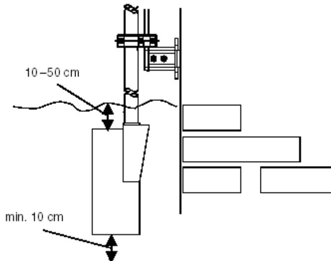
图 4 模块容器固定安装要求
