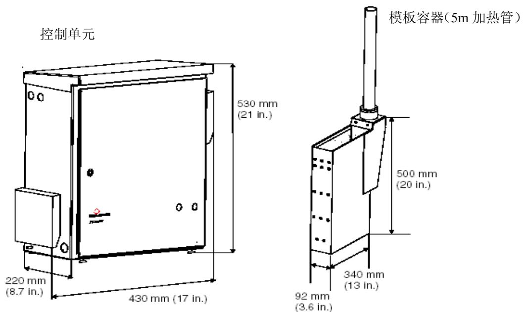
图 2 控制单元和模块容器尺寸
