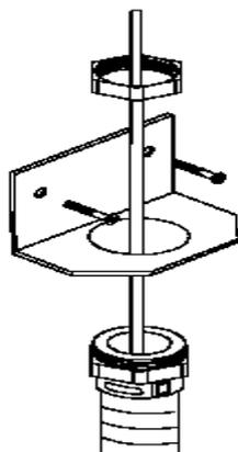
图 10 样品运输软管的角形托架
