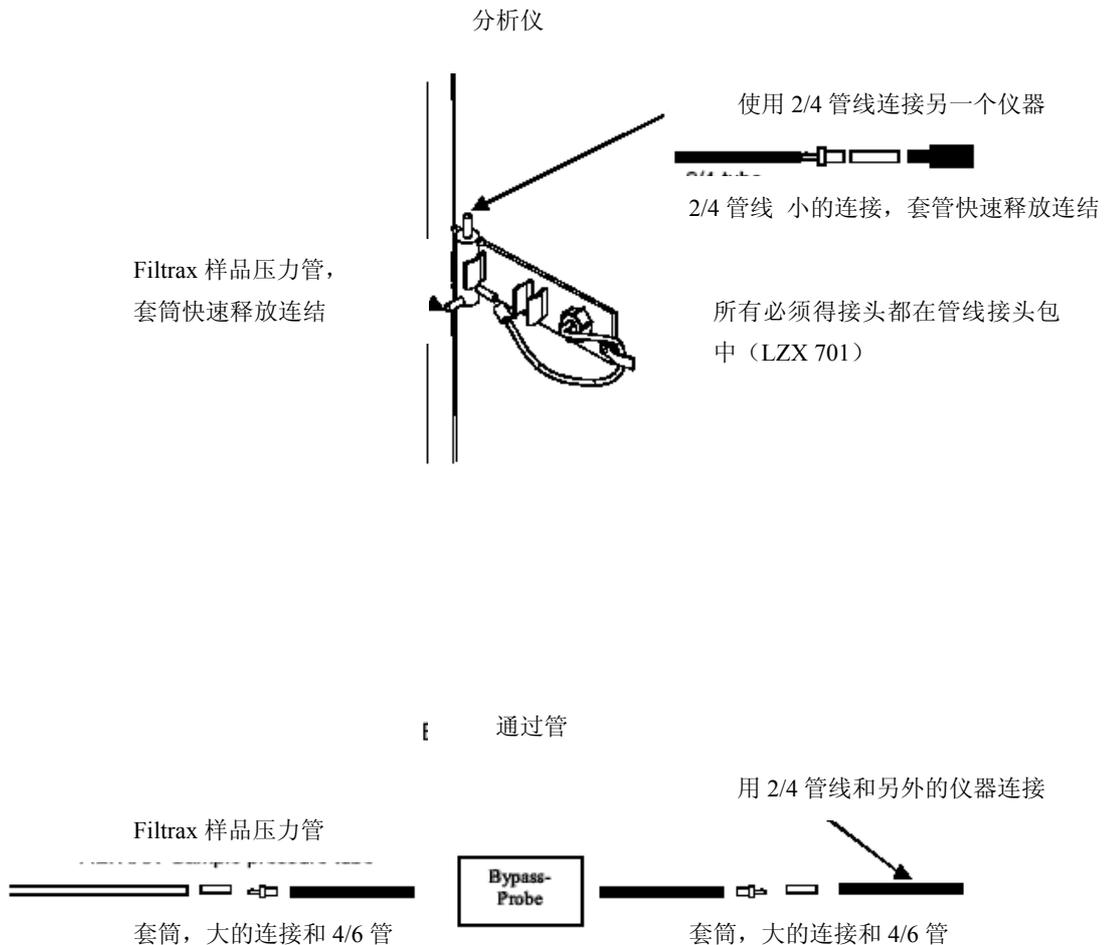
图 12 把在线测量装置和 Filtrax 连接
