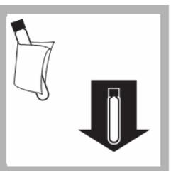
12、擦干净样品消解管的外表面，然后插入 DR2800 试管固定架。
