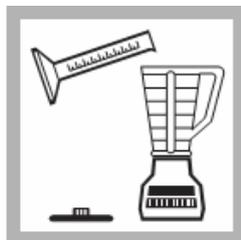
1、如样品含有悬浮固体，在搅拌器中对样品进行 30 秒均匀化处理。如不含有悬浮固体，跳过此步骤。
