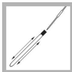
3、样品准备：打开一支 COD 消解试管，将 2.00 mL 样品加入到试管中，拧紧盖子。
