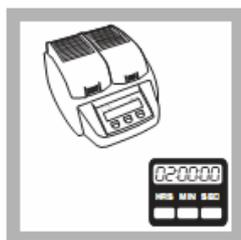
6、消解 2 小时。结束后关闭消解器，等待大约 20 分钟，使试管冷却到 120°C 甚至更低的温度。
