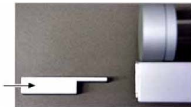
图 108 缩短固体测定模块的调节垫位置
