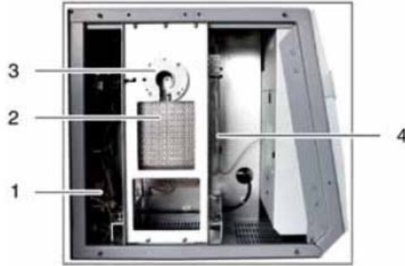
图2 IL530 TOC-TN的左视图（去掉侧面板后）
