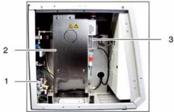
图5 IL550 TOC-TN的左视图（去掉侧面板后）
