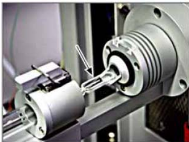
图 105 固体测定模块和燃烧炉进样口打开状态（箭头指的是燃烧舟）
