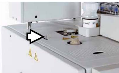
图7 无进样垫的进样口的手动转换开关
