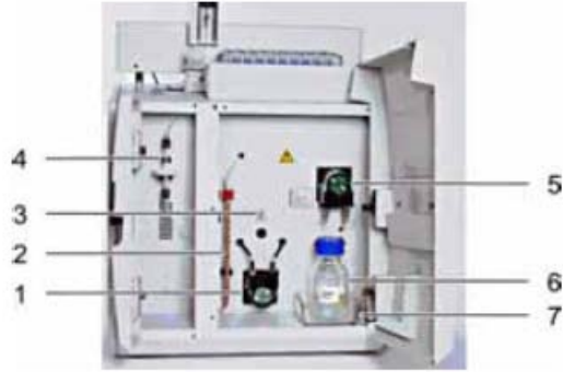
图4 IL550 TOC-TN的前视图（门打开）
