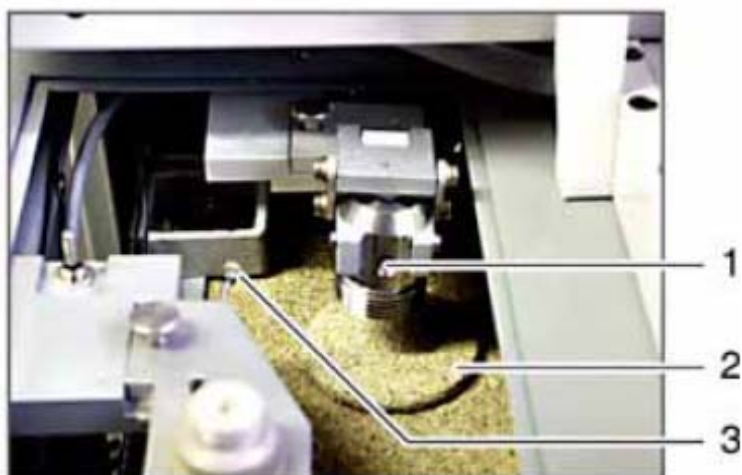
图 101 反应管垂直移除
