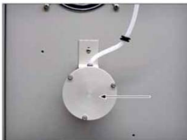
图 111 灰尘捕集（去除保护罩）
