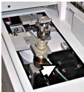
图17 旋管冷凝器（上面板打开）
