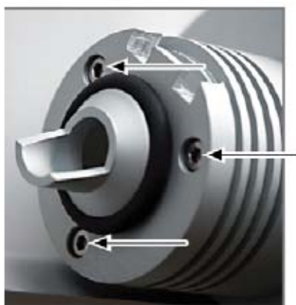
图 99 紧固反应管的六角螺丝
